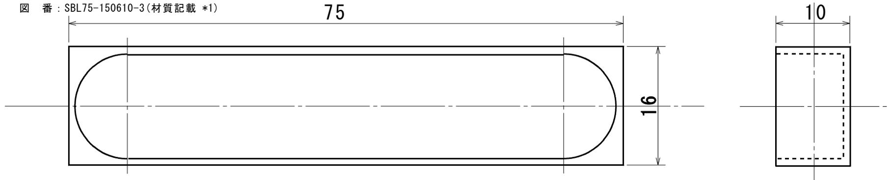
\*1 材質 : セラミックス (酸化物・炭化物・窒化物等)
